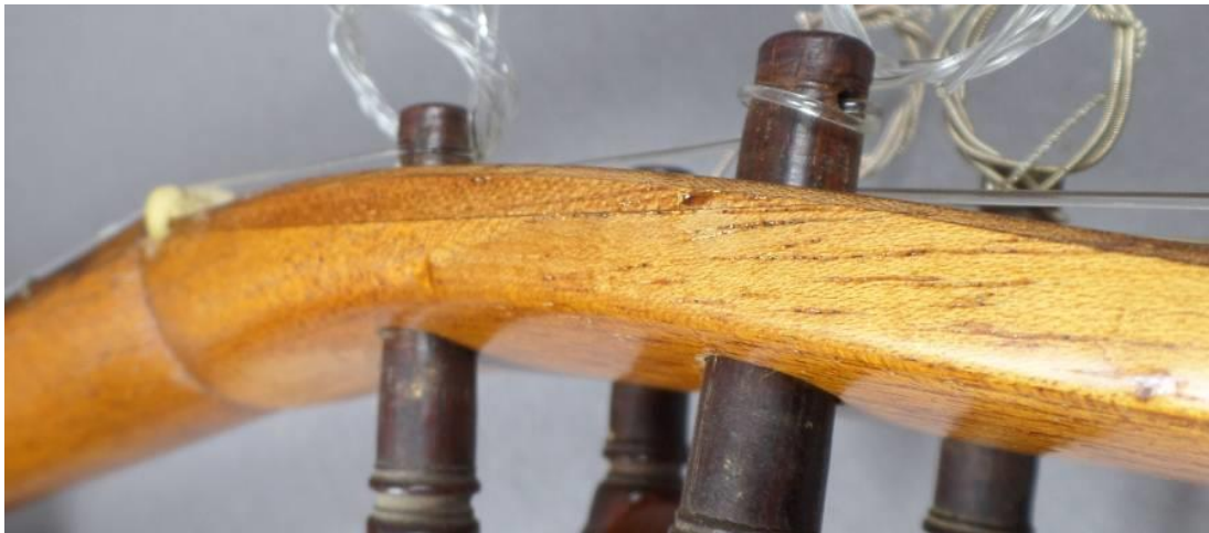
Ilustración 201: Pieza de regreoso en el clavijero con la chapa (forro de pala) de caoba
