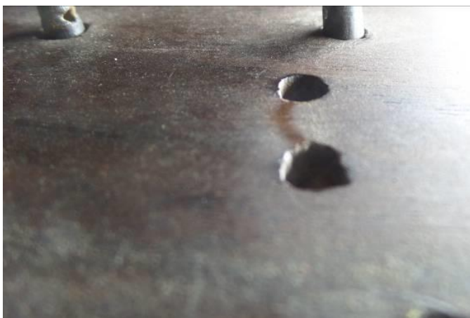
Ilustración 140: Surco elaborado por la cuerda de sujeción (no se ha conservado)
