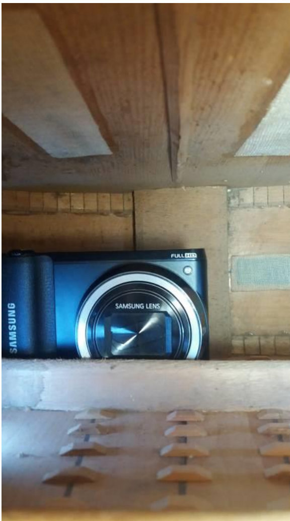
Ilustración 19: Cámara dentro del instrumento para hacer fotografías en modo remoto
