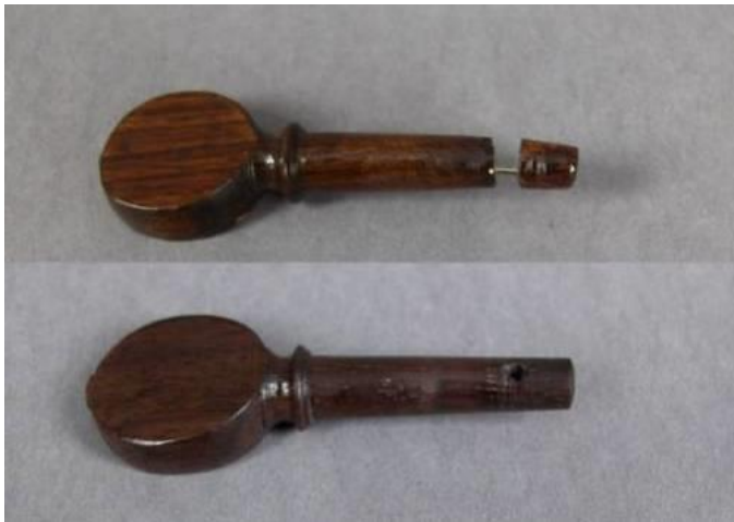
Ilustración 108: Clavija rota y la clavija nueva torneada
