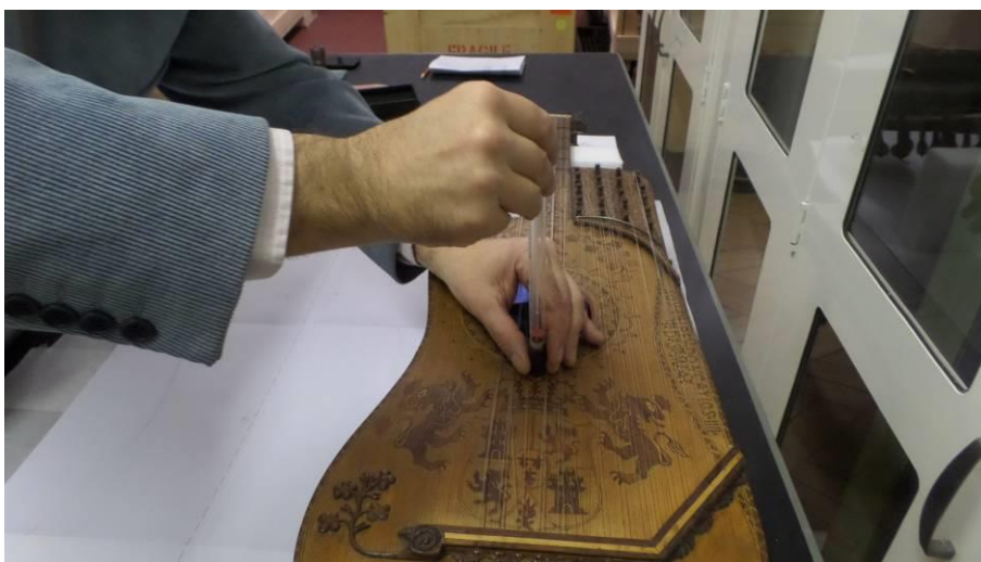
Ilustración 11: Medida del grosor de la tapa con espesímetro de émbolo
