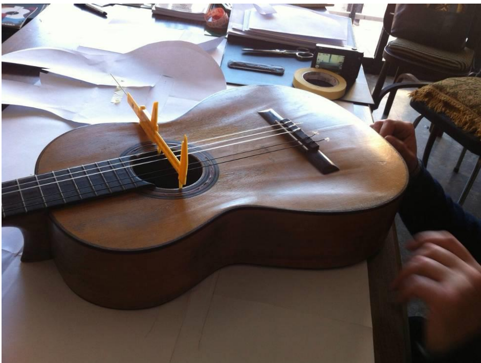
Ilustración 13: Determinación de barras por observación a luz rasante
