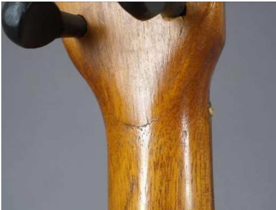
Ilustración 137: Unión al sesgo de cabeza y mástil
