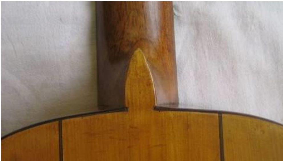
Ilustración 166: La leona, unión mástil-caja.
